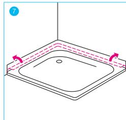
7 Wannendichtband hochlegen und auf Verbundabdichtung plan aufbringen. Mit der Hand oder einer Anpresswalze gut andrücken.
