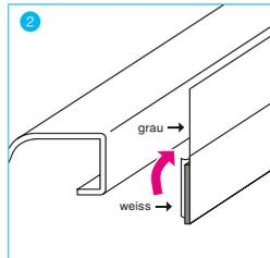
2 Abdeckfolie des unteren Butylstreifen von der Innenseite des Wannendichtbandes entfernen und an den Wannenrand faltenfrei ankleben. An dem Wanneneck spannungsfrei herumführen.
