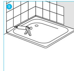
9 Die Fliesen mit einem Abstand von ca. 5 mm OK-Wannenrand aufbringen. Nach dem Fliesen in die entstandene Fuge ein Fugenhinterfüllprofil (Rundschnur) einlegen und anschliessend mit Sanitär silikon ausfüllen.
