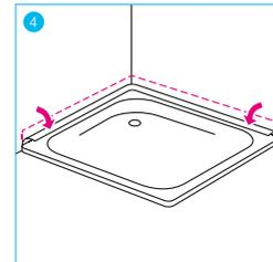
4 Wanne standfest montieren / Ablauf anschliessen. (Dichtigkeitskontrolle) Wannendichtband herunter legen.
